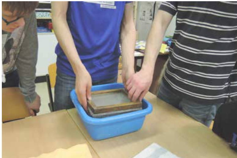
Aus den Faserbrei wird ein Bogen Papier geschöpft.
